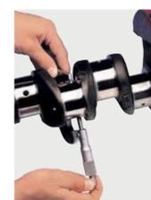
Für den Wellendurchmesser gelten die im Katalog angegebenen Toleranzen. Einzelkontrolle auf Einhaltung der Toleranzen für Rundheit und Parallelität.
