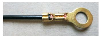
Nach einer solchen Montage kann man den Anschlußbereich des Kabelschuhes entweder einem Schrumpfschlauch oder wie unten abgebildet, mit einer Gummitülle isolieren. Diese Gummitüllen gibt es in allen Orinalfarben, die im Traction-Kabelbaum vorkommen.
