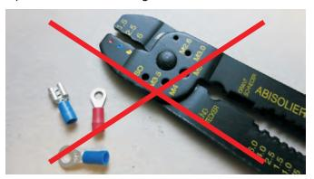
Allerdings wird für die Montage der links gezeigten System-Kabelschuhe eine spezielle Montagezange benötigt. Sie bietet die nötige Kraft um in einem Arbeitsgang beide Bördelungen ordentlich auszuführen.
