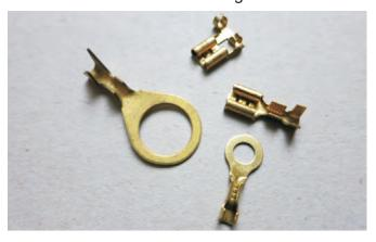
Von einer Verwendung des unten gezeigten Anschlußsystems muß wegen der unsicheren Kabelhaltung und -verbindung sowie aus optischen Gründen abgeraten werden.
