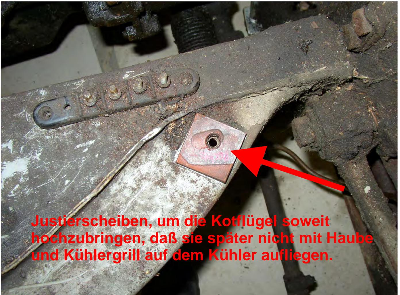
**Justierscheiben, um die Kotflügel soweit hochzubringen, daß sie später nicht mit Haube und Kühlergrill auf dem Kühler aufliegen.**
