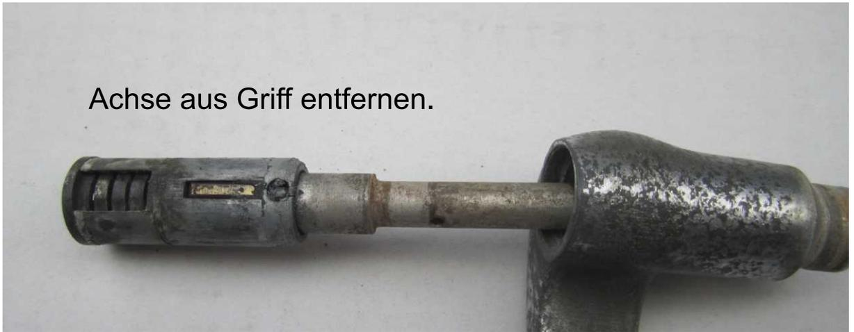
Achse aus Griff entfernen.
