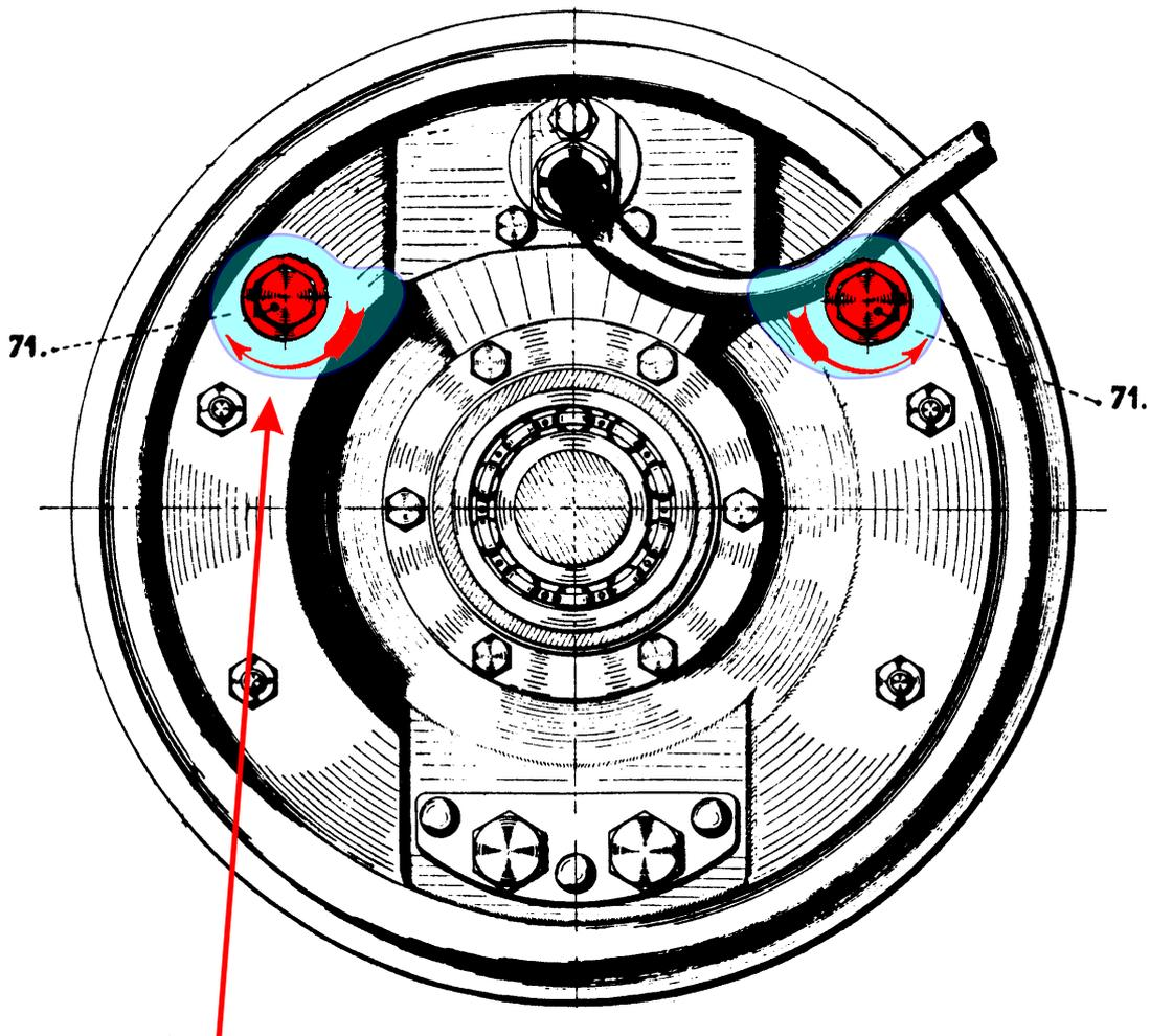
Zum Strammerstellen der Bremse müssen die beiden Schraubenköpfe (Nr. 71) in Pfeilrichtung gedreht werden, um so die innen liegenden (bläulichen) Excenter zu verstellen.
