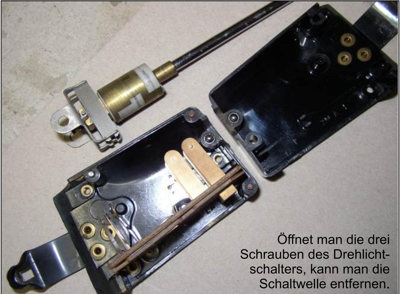
Öffnet man die drei Schrauben des Drehlichtschalters, kann man die Schaltwelle entfernen.
