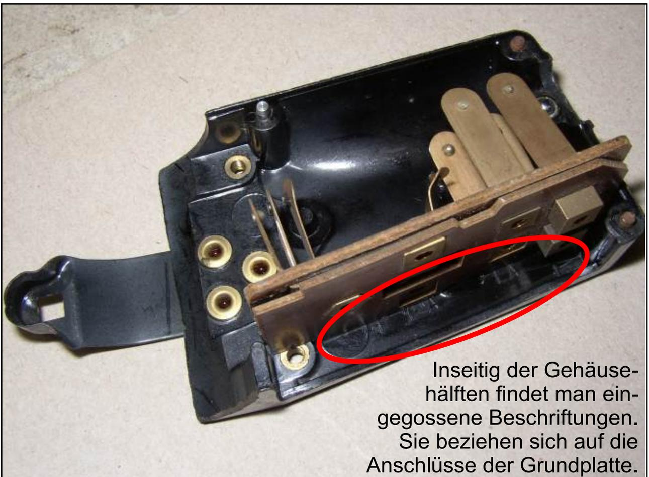
Inseitig der Gehäusenhälfte findet man eingegossene Beschriftungen. Sie beziehen sich auf die Anschlüsse der Grundplatte.
